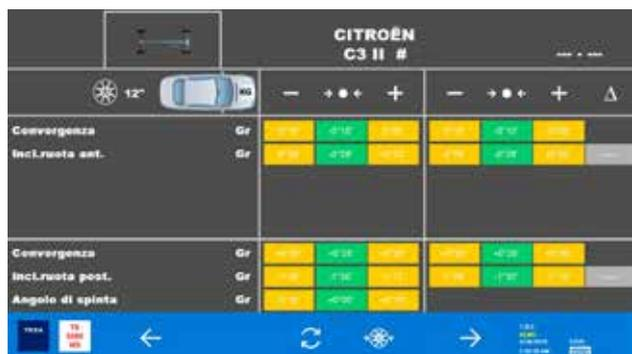
En phase de vérification de l'assiette, le logiciel définit le diamètre des pneus et affiche les plages de convergences, semi-convergence et l'angle de poussée.
