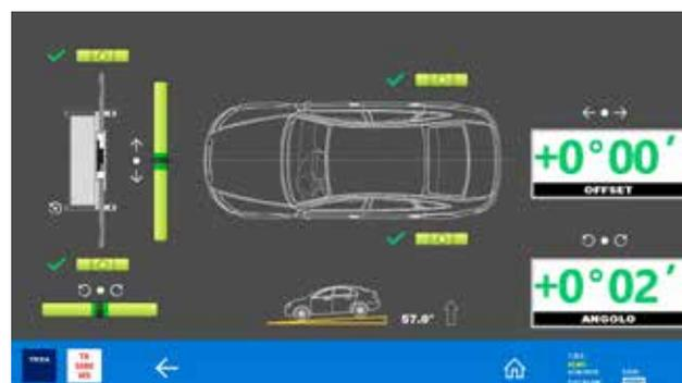
La structure est donc alignée au véhicule et il est possible de procéder à la calibration des radars ou de la caméra.
