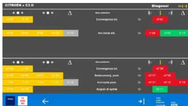
Ecran récapitulatif des données relevées par les quatre capteurs CCD, par rapport aux valeurs nominales établies par le constructeur. Si ces valeurs entrent dans les tolérances, il est possible de procéder au positionnement du RCCS 2.
