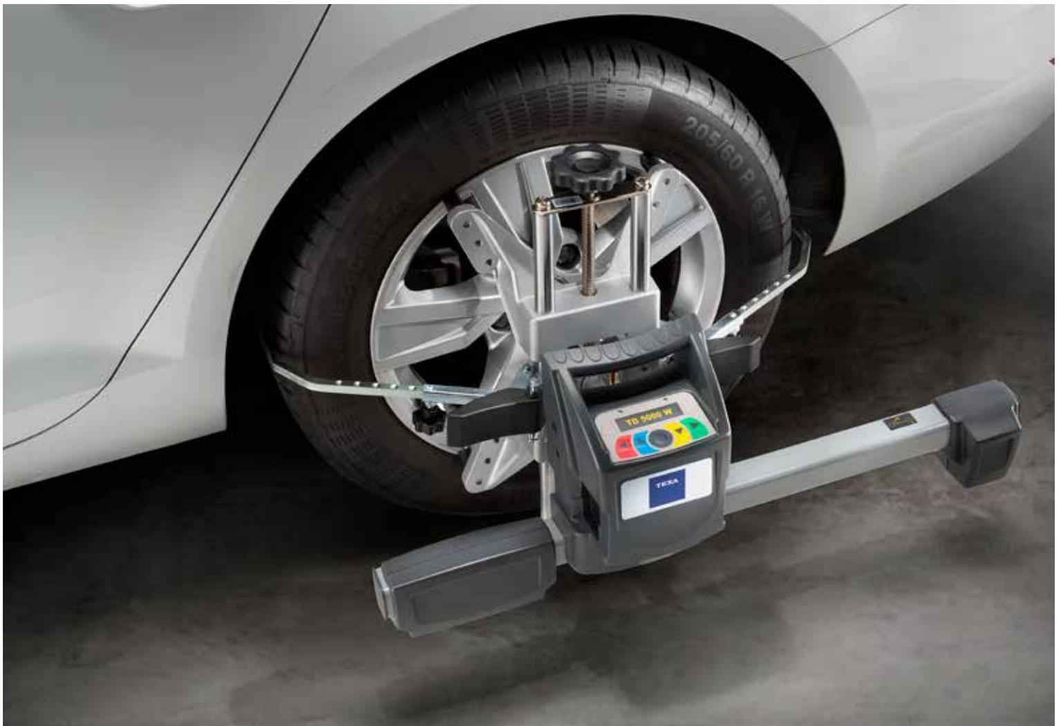
**Détecteur électronique CCD**, muni de capteurs infrarouges. La légèreté des détecteurs et l'absence de câble d'alimentation entre l'avant et l'arrière assurent une praticité d'utilisation maximale ainsi qu'une précision absolue dans la mesure des angles du véhicule.
