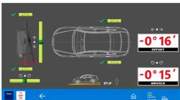
Le libellé « OFFSET » indique quand le RCCS 2 n'est pas centré par rapport à la ligne médiane du véhicule. « ANGOLO » indique lorsque l'angle de la structure n'est pas aligné par rapport au véhicule.
