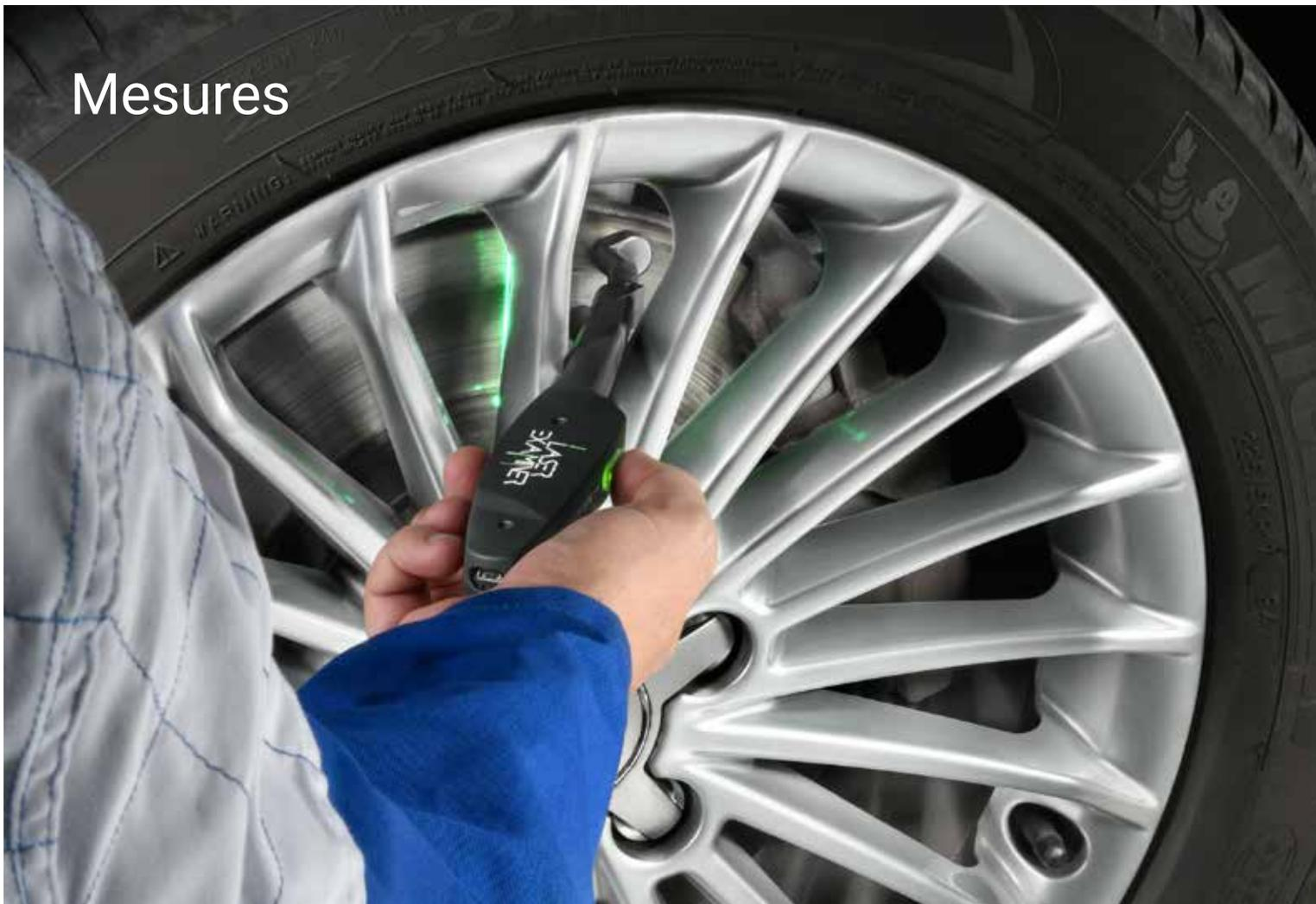
LASER EXAMINER est la nouveauté TEXA concernant les outils de mesure : laser profilomètre innovateur afin de vérifier l'usure des disques de frein et de la bande de roulement des pneumatiques.
