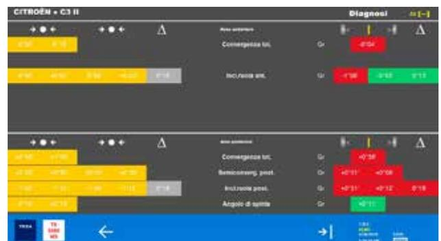
Ecran récapitulatif des données relevées par les quatre capteurs CCD, par rapport aux valeurs nominales établies par le constructeur. Si ces valeurs entrent dans les tolérances, il est possible de procéder au positionnement du RCCS 2.
