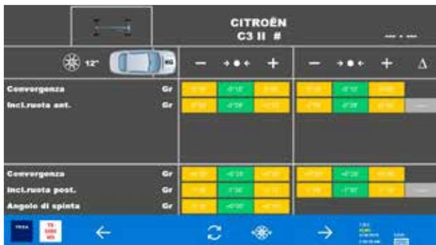
En phase de vérification de l'assiette, le logiciel définit le diamètre des pneus et affiche les pages de convergence, semi-convergence et l'angle de poussée.
