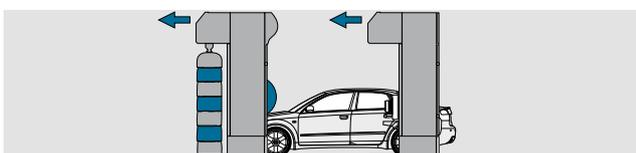
Le portique sécheur se déplace avant la fin du lavage. Séchage en un seul passage portique (gain de temps).
