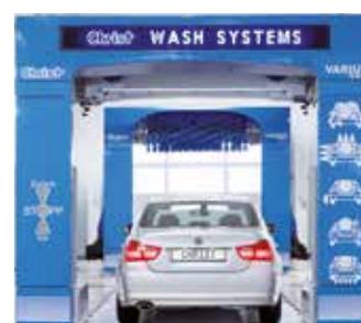
Ce portique „double» se compose d’un portique lavage et d’un portique séchage. Cette dualité permet plusieurs fonctions en parallèle. Exemple : lavage avec mousse active, lavage brosses, auto-séchant et séchage en 2 passages. Un sècheur spécial de 16 kW au total permet de sécher sans aucun problème en 1 seul „passage séchage”.
