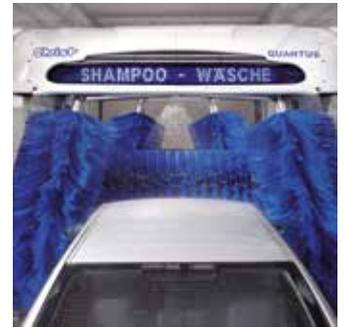
Ce portique à 5 brosses est la bête de somme de la gamme Christ. Conçu pour les stations à très gros débit à un endroit limité en place. Les 4 brosses verticales et la HP Vitesse en option, on peut laver jusqu'à 16 véhicules/h dans un hall de 10 m de long. Pour que le séchage ne rétrograde pas en vitesse par rapport au lavage, Christ installe une soufflerie HighEnd en augmentant sa puissance de 1,6 kW.
