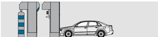
Positionnement du véhicule devant le portique sécheur. Le portique laveur se trouve derrière le portique sécheur, dans sa position de départ.
