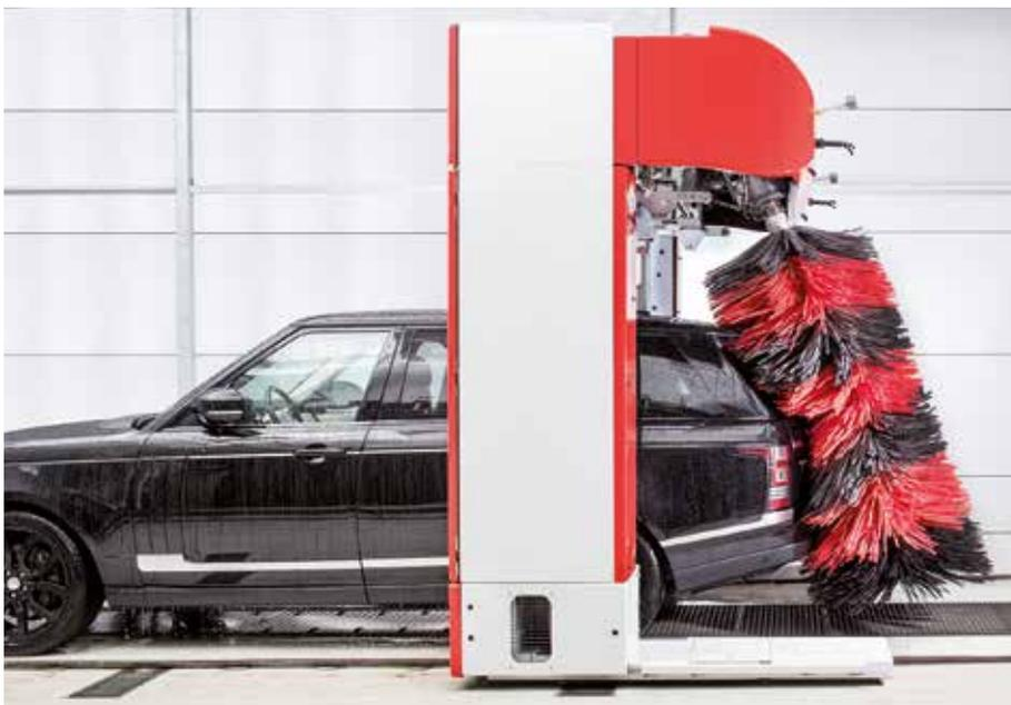
MAXI FLEX+ est également combiné avec la brosse articulée. L'inclinaison des brosses à l'arrière s'adapte aisément au suivi de contours du véhicule lors du lavage latéral. Pour les véhicules avec partie arrière droite (par ex. les VUL), les 2 brosses latérales restent suspendues perpendiculairement. Disponible jusqu'à une hauteur de passage maxi de 2.400 mm.
