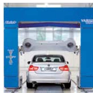
Un tunnel de lavage sous forme de portiques : avec ses 2 portiques placés séparément, il permet une capacité de lavage deux fois plus élevée qu'un portique normal.
