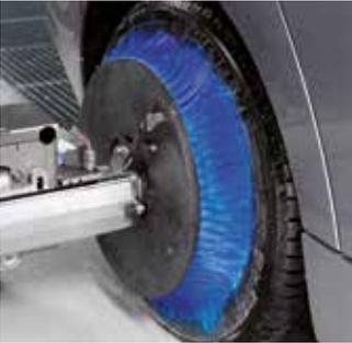
Arrosage HP des brosses de roues. Différents diamètres de jantes et un nombre variable de buses HP possibles. Grâce à des appuis répétés et un double sens de rotation des brosses, même les endroits difficilement accessibles sont parfaitement lavés.
