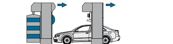
Le portique sécheur se déplace vers l'entrée de la baie de lavage. Selon l'équipement de la machine, lavage HP et application mousse pendant le déplacement du portique sécheur.
