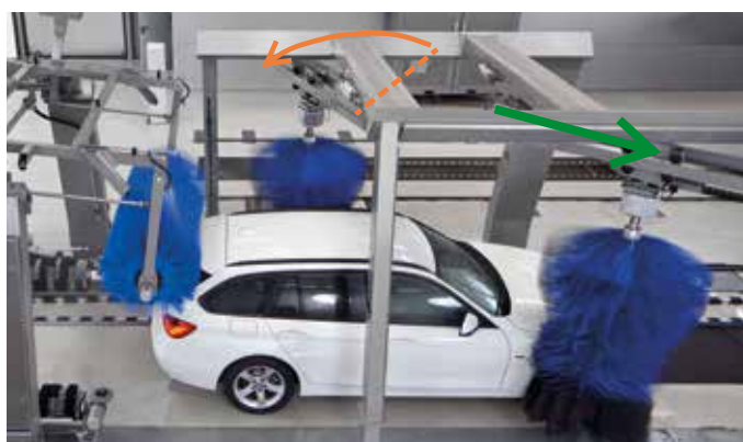
Le rail de roulement de gauche pivote en position de lavage arrière (flèche orange). La brosse latérale droite est poussée vers l'extérieur droit par la voiture = le lavage avant droit a été réalisé (flèche verte).
