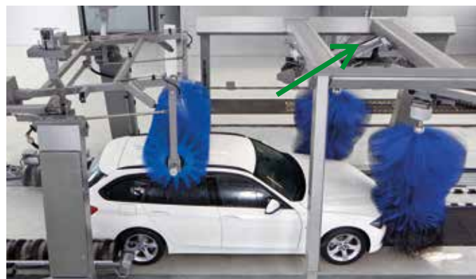
La brosse latérale gauche est poussée vers l'extérieur gauche par la voiture = le lavage avant gauche a été réalisé (flèche verte). Parallèlement, le lavage avant droit débute.
