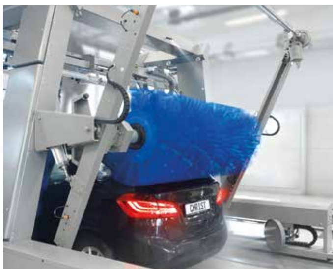
Le rail de roulement se trouve en position de lavage arrière.
