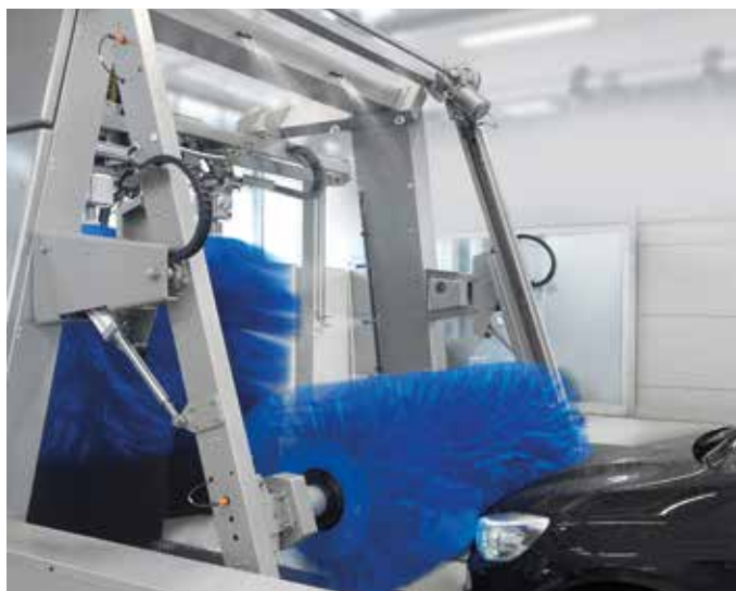
Le rail de roulement se trouve en position de lavage avant.
