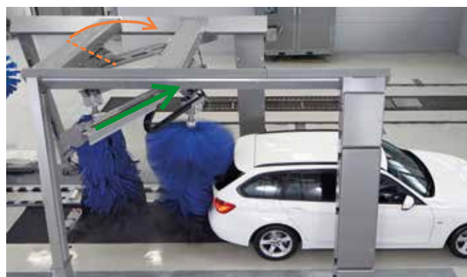
Le rail de roulement de gauche pivote à nouveau en position de lavage avant. Le véhicule suivant peut venir. La brosse latérale droite se déplace le long du véhicule = Début du lavage arrière droit (flèche verte).
