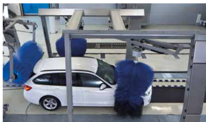
La brosse latérale gauche lave la surface latérale gauche. La brosse latérale droite lave la surface latérale droite (le rail de roulement droit ne se trouve pas encore en position de lavage arrière).
